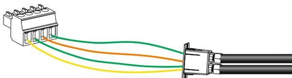
**Fase 5** Inserire il connettore 4pin nel corrispettivo connettore femmina 4pin della COM2 dell'inverter e fissare la copertura COM2 impermeabile con le viti rimosse in precedenza. Serrare le viti ed i pressacavi della copertura impermeabile con una coppia di 0.8Nm.
