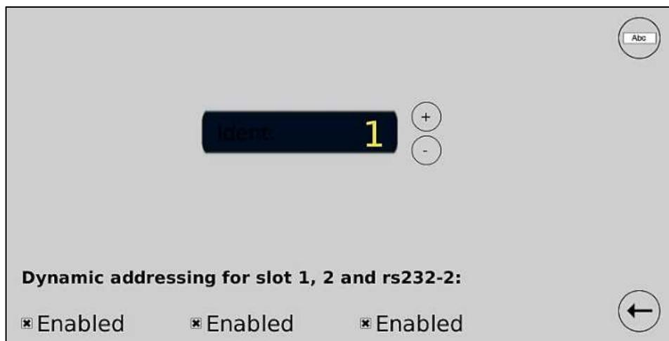
Nella stessa finestra è possibile, per ogni porta seriale, indicare se l'indirizzamento è dinamico o statico <sup>1</sup>, questo è un aspetto tecnico che riguarda la compatibilità dei protocolli di comunicazione; in particolare questo dato di configurazione riguarda il protocollo PVSER (Protocollo Proprietario).
