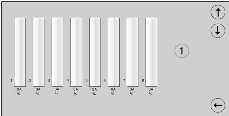
In questa finestra è possibile cambiare il parametro "peso" per ciascun ingresso a secondo dei pannelli fotovoltaici collegati, premendo il relativo tasto "%", situato sotto ad ogni misura.
