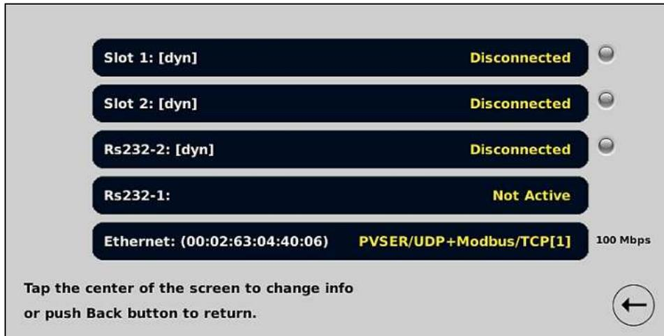
In questo esempio vediamo una connessione PVSER/UDP e Modbus TCP sulla porta Ethernet ed una connessione ad una misura esterna sulla seriale n°2 che in questo caso sono le misure di correnti del DC-BOX.
