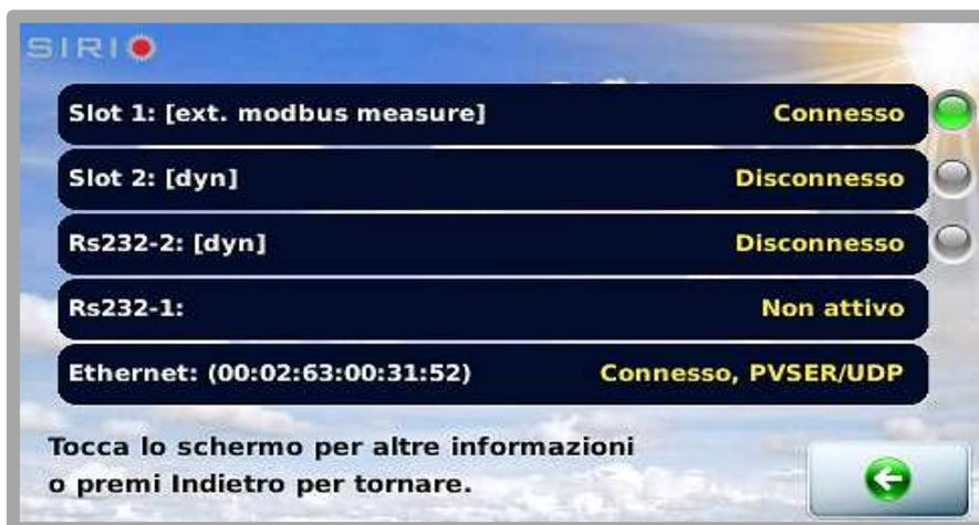
In questo esempio vediamo una connessione PVSER/UPD sulla porta Ethernet ed una connessione ad una misura esterna sullo slot 1.
