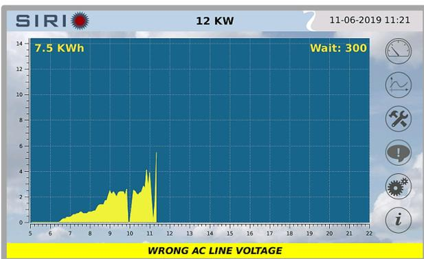
**ALLARME:** La barra di stato diventa "GIALLA" significa che le condizioni di irraggiamento sono buone, ma l'inverter non parte a causa di problemi temporanei come ad esempio tensione della rete non idonea, sovratemperatura dell'inverter, ecc. Nella parte inferiore dello schermo scorrono una serie di messaggi che spiegano la tipologia di allarme. Vedere la sezione successiva per una spiegazione dei messaggi.
