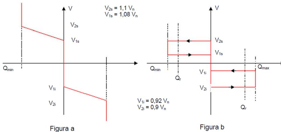
Il tasto 2 permette di accedere all'impostazione dei punti della curva caratteristica definita dalla norma CEI 0-21. I primi due punti che vengono regolati sono  $V_{1i}$ , e  $V_{2i}$  espressi in percentuale della tensione nominale dell'inverter.
