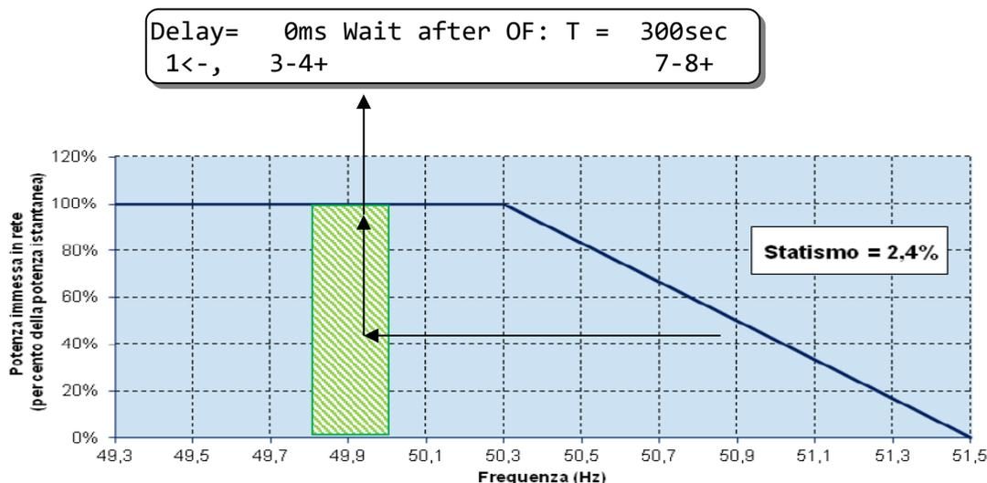
Al superamento della frequenza fstart, la potenza attiva di uscita viene ridotta all'aumentare della frequenza secondo un parametro definito "statismo". Il valore di default 2.4% porta la potenza a zero ad una frequenza di 51.5Hz. Nell'esempio la frequenza di rete ha raggiunto il valore di 50.95Hz e quindi la potenza massima viene ridotta al 45% della potenza immessa nell'istante in cui la frequenza ha superato i 50.3Hz (Pm).
