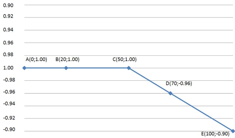
Il tasto 2 permette di accedere al set del primo punto della curva caratteristica (A)
